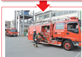
止め金具を外し、3本巻きの吸管の全てを持って、車外へ引き出す。 このとき、手は吸管の上部を下から抱きかかえるように持ち、吸管の重量を生かして手前に倒すように引き出す（写真はハード吸管使用）。
