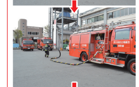
止め金具を外し、3本巻きの吸管の全てを持って、車外へ引き出す。 このとき、手は吸管の上部を下から抱きかかえるように持ち、吸管の重量を生かして手前に倒すように引き出す（写真はハード吸管使用）。
