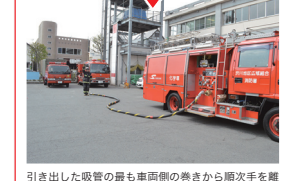
引き出した吸管の最も車両側の巻から順次手を離し、車両後方へ走りつつ、よれを直しながら吸管を伸長する。
