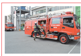
止め金具を外し、3本巻きの吸管の全てを持って、車外へ引き出す。 このとき、手は吸管の上部を下から抱きかかえるように持ち、吸管の重量を生かして手前に倒すように引き出す（写真はハード吸管使用）。
