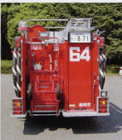
5.5トン級のシャシをベースにA-2級ポンプ、水槽1,500L等を積載した車両。水難救助対応のゴムボートを車両上部に積載できるよう、脱着可能なフレームを設けている。 (福岡市消防局)
