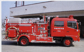
4トン級シャシをベースにA-2級ポンプを搭載した水槽付消防ポンプ車。上部に放水銃を備えている。 (甲府地区広域行政事務組合消防本部)
