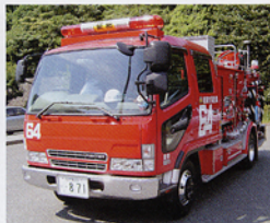
5.5トン級のシャシをベースにA-2級ポンプ、水槽1,500L等を積載した車両。水難救助対応のゴムボートを車両上部に積載できるよう、脱着可能なフレームを設けている。 (福岡市消防局)
