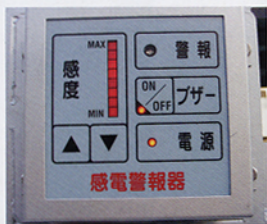
感電警報器 (北九州市消防局)
